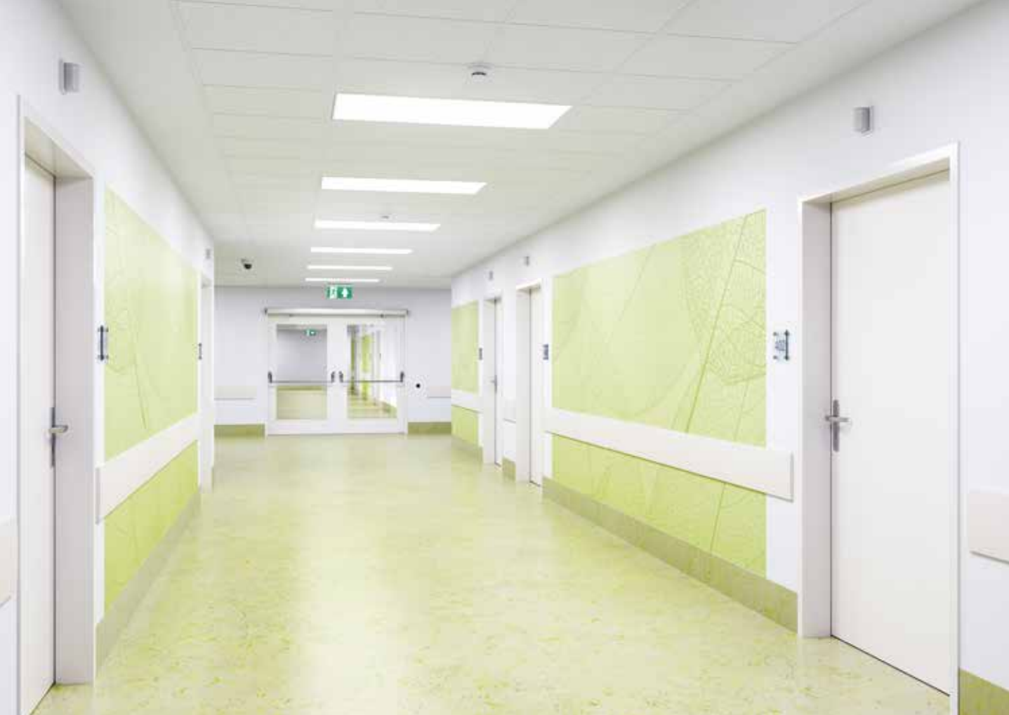
Schallschutztüren in Getalit® A 222, 2-flügelige Brandschutztür mit Lichtausschnitt LA-1000 in Getalit® A 222, Verglasung Klarglas Soundproof doors in Getalit® A 222, double-leaf fire door with glass opening LA-1000 in Getalit® A 222, transparent glazing
