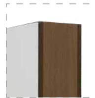
Eckige Kante, stumpf mit Einleimer Chant carré, droit avec alaise embrevée
